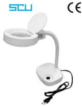
Tipo con luce, con base da appoggio. In materiale ABS, coperchio e luce da 11 W. Con lente bifocale in vetro silicato, Ø mm 85 e lente "SPOT", Ø mm 20. Ingrandimenti 3x, 5x. Collegamento a rete 230 V.
